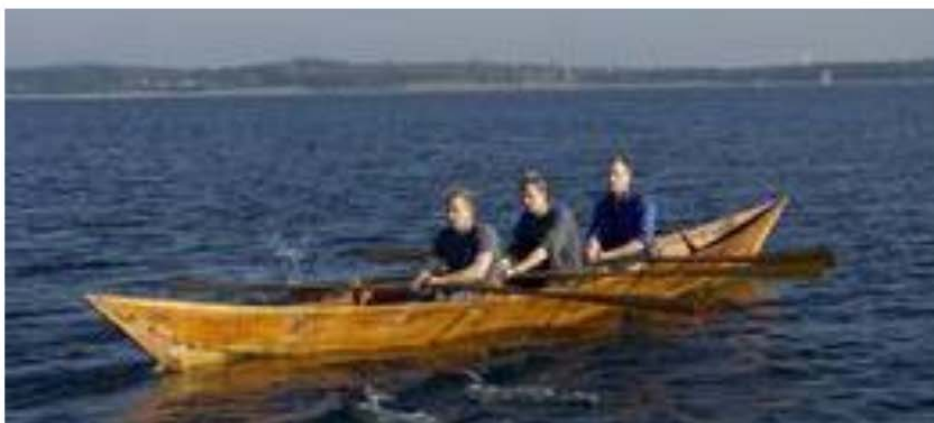
Bilddokumentation av Vikingeskibsmuseets rekonstruktion av Björkebåten. Bottenstocken spändes ut med upphettning och stenar.
