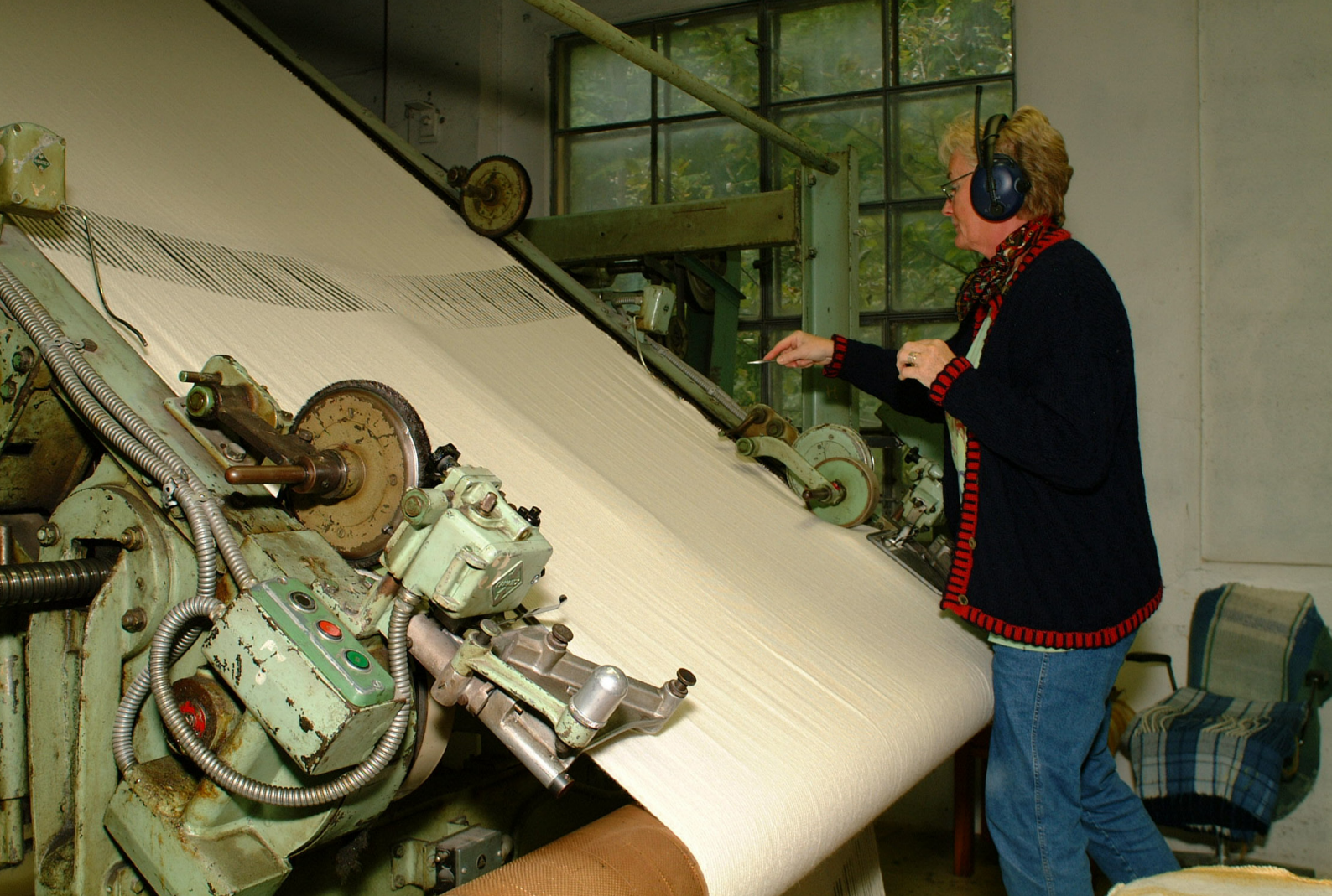
Arbeid ved tørkemaskinen, Berger fabrikker.
