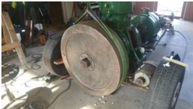
14.Motor montert på tralle med el-motor for testkjøring
