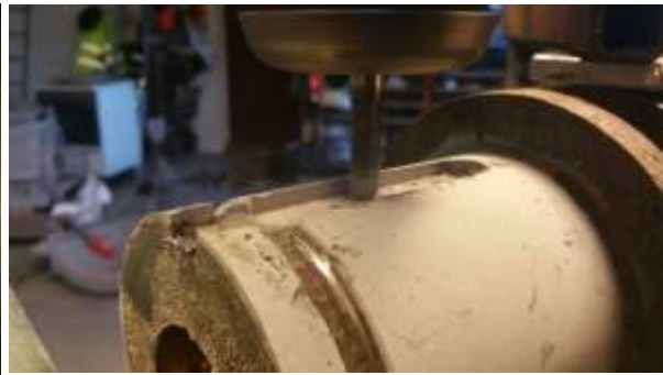
11. Fresing av kilespor i drivaksel ut fra gir
