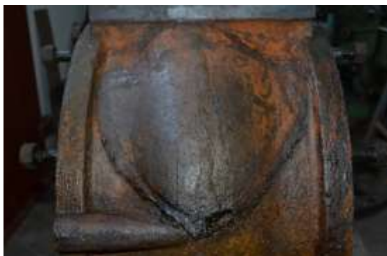
8.Skade på veivhus utvendig
