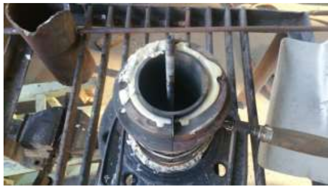
13. Støping av lagre
