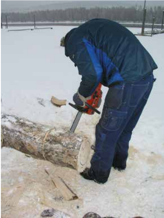
Haakon Skoglunn skjærer bort overskytende treverk. Først forsaging med motorsag.
