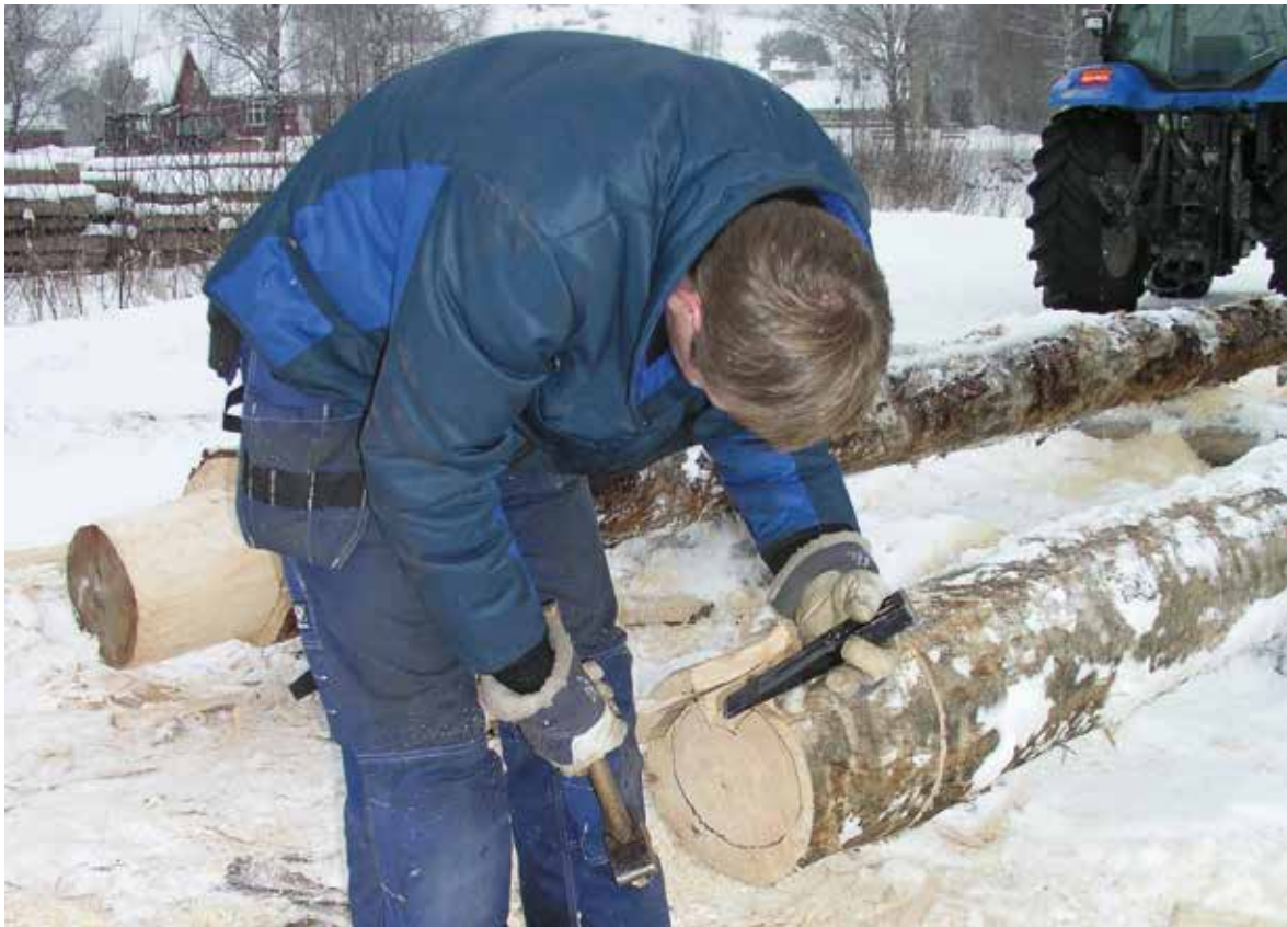
Over: Treverk fjernes med slegge og kile. Under: Motorsag, kile og slegge er den effektive måten å forme lenseendene. Noen blir også formet med øks.
