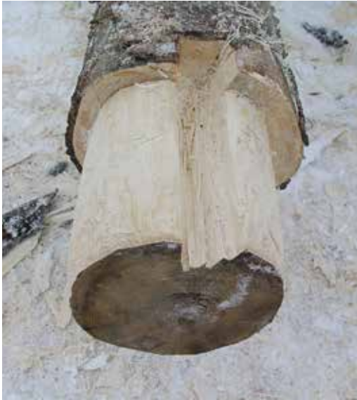
Ferdigutformet lenseende med spor til kjetting sett forfra og fra siden.
