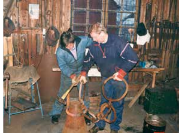
Finn Karlstad og Bjørn Sundbakken retter opp en ring som er blitt flat.
