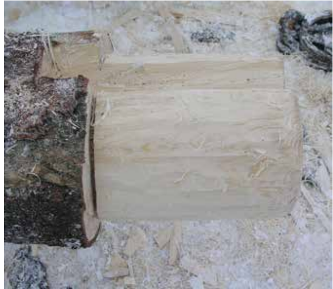
Ferdigutformet lenseende med spor til kjetting sett forfra og fra siden.
