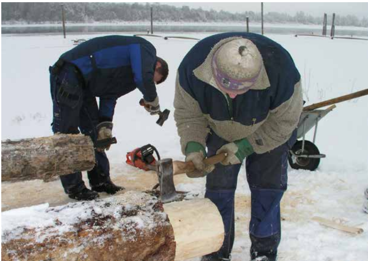
Over: Treverk fjernes med slegge og kile. Under: Motorsag, kile og slegge er den effektive måten å forme lenseendene. Noen blir også formet med øks.
