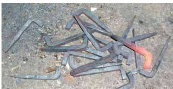
Ferdig smidde dogg. 456 dogg gikk med til 300 meter doble lenser.
