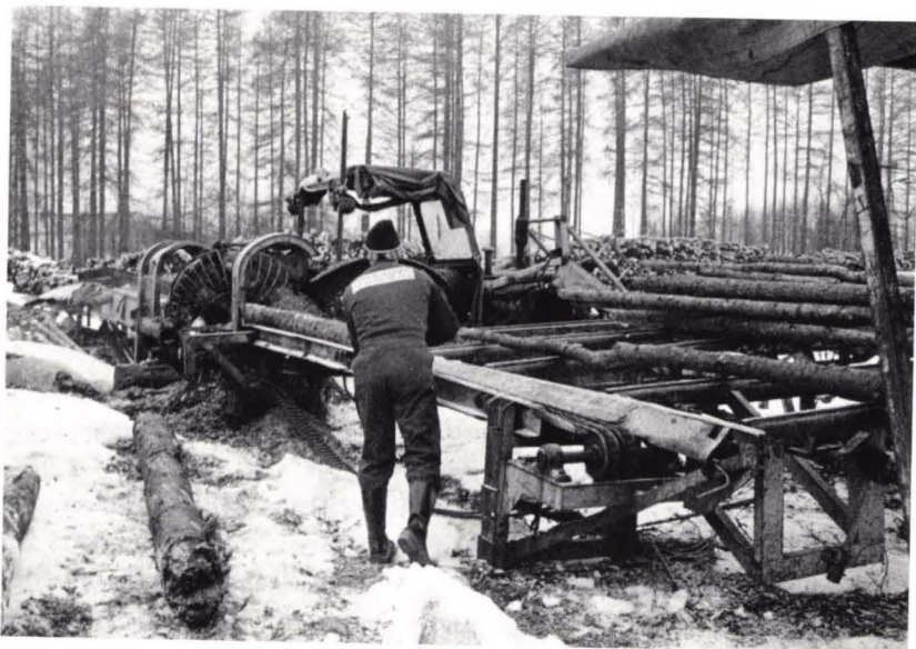
Cambiobarkeanlegget i drift på barkeplassen ved Kongsvinger. Det er gitt som gave til museet av Borregaard Industries Ltd. A/S. Foto: O.T.L.
