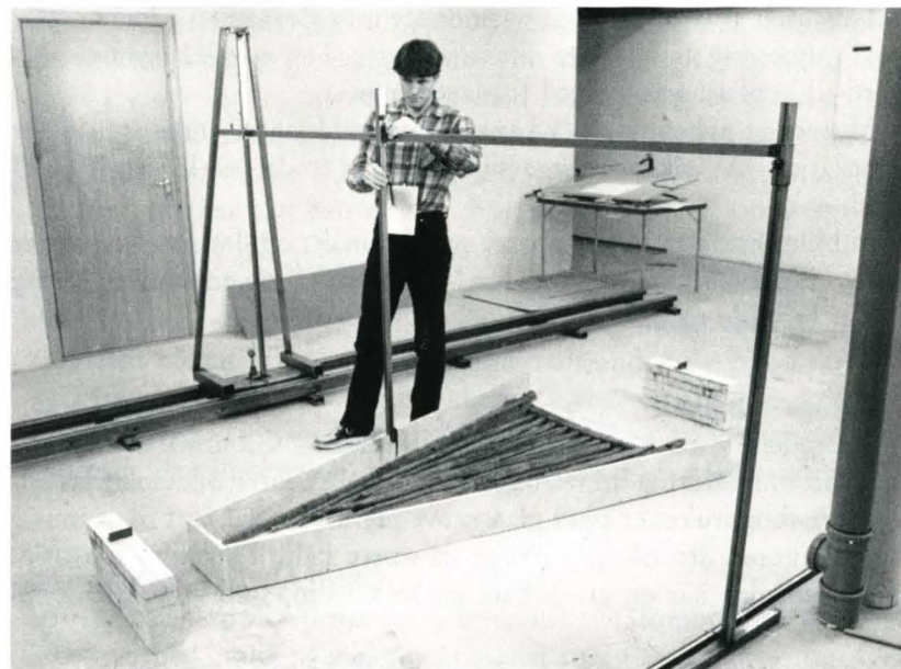
Werner Øien i sving med oppmåling av fiskesløe fra Tesse. Den nye oppmålingsinnretningen er først og fremst beregnet på båter, men alle større gjenstander kan oppmåles og tegnes ved hjelp av denne. Foto: O.T.L.
