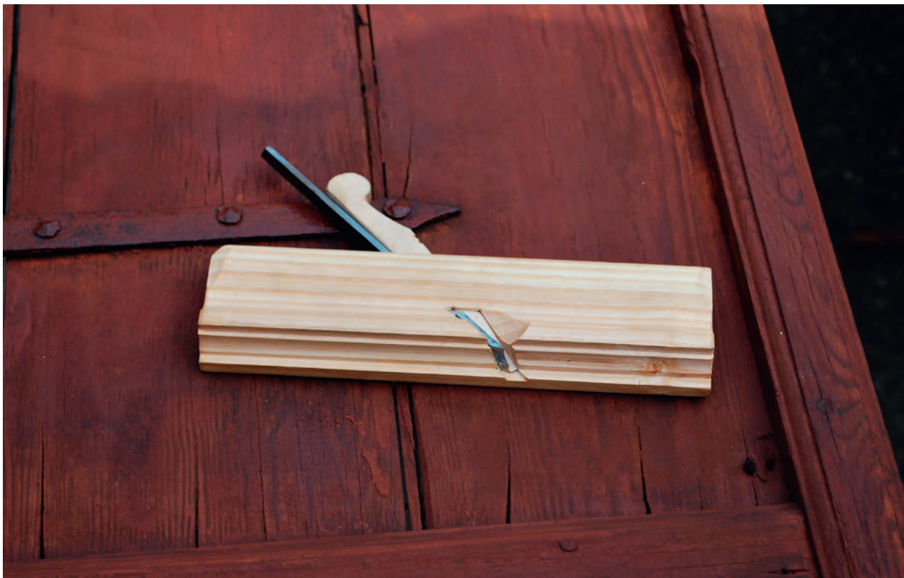
Vindusskodde (Baznica gate 28) og profilhøvel som passer til dekklisten til høyre. Høvelen er ny og laget av Jarle Hugstmyr (NHU), som var en av kurslærerne på workshopen.
