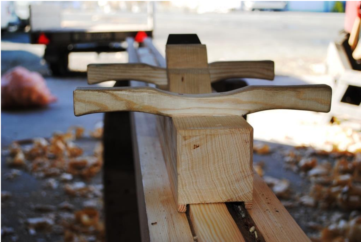
Strykebenkar (skottbenk, rettbenk, føybenk) og kopiar av gamle høvlar er blitt ein populær sjanger mellom museumshandverkarar. Foto: Ryfylkemuseet.
