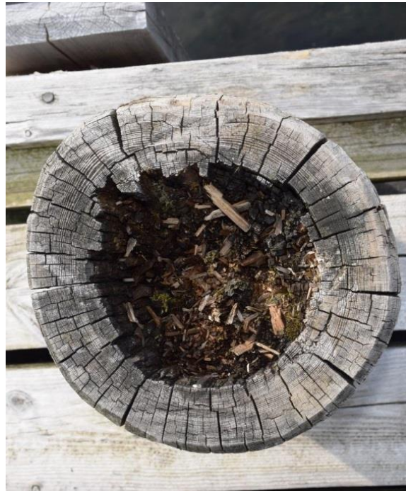
Heller ikkje kreosotinimpregnerte telefonstolpar varer evig. Denne har stått som bryggetolpe utfor Ryfylkemuseet på Sand i 30 år.
