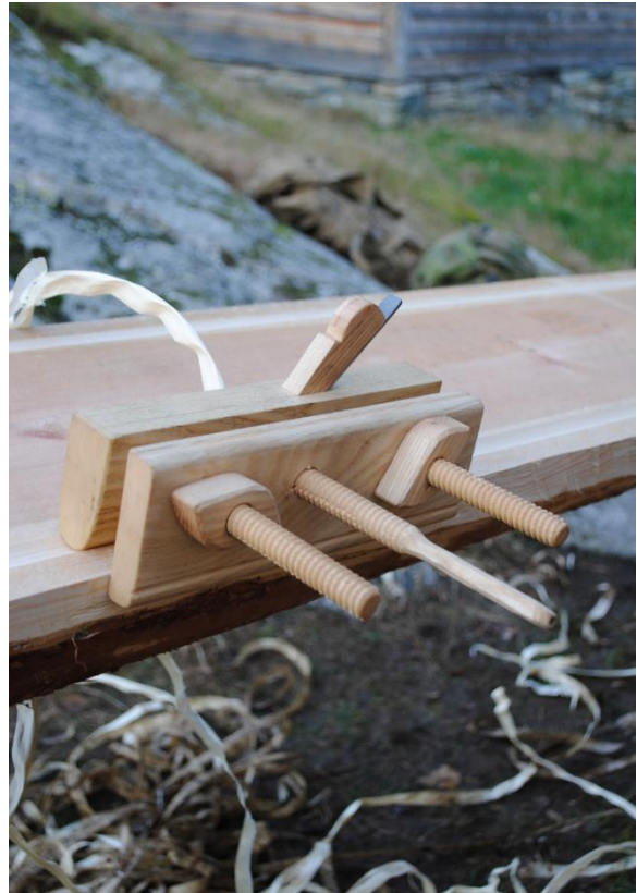
For å høvle ut vassrenner blei det laga kopi av ein hundragshøvel i samlinga til museet. Foto: Ryfylkemuseet.
