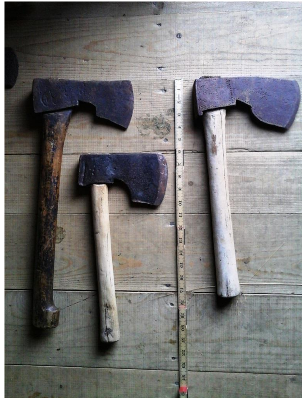
Økser frå same tida som laftet vil bli kopierte for å prøve ut lafting med økser som blei brukte på den tida laftet blei hogge. Foto: Sven Hoftun, Ryfylkemuseet.
