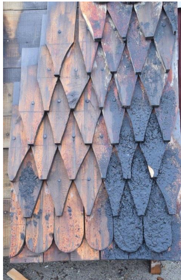
Rørosmuseet gjer forsøk med behandling av spontak for å finne ut kva som gjer at det kan ligge lenge.
