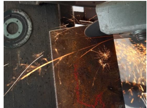
BILDE 2 GNIST FRA STÅL MED 0,75 % KARBON
