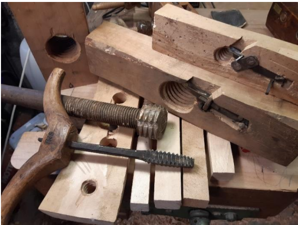
FIGUR 1 GJENGEVERKTØY/GJENGESETT FRA SKOLTE
