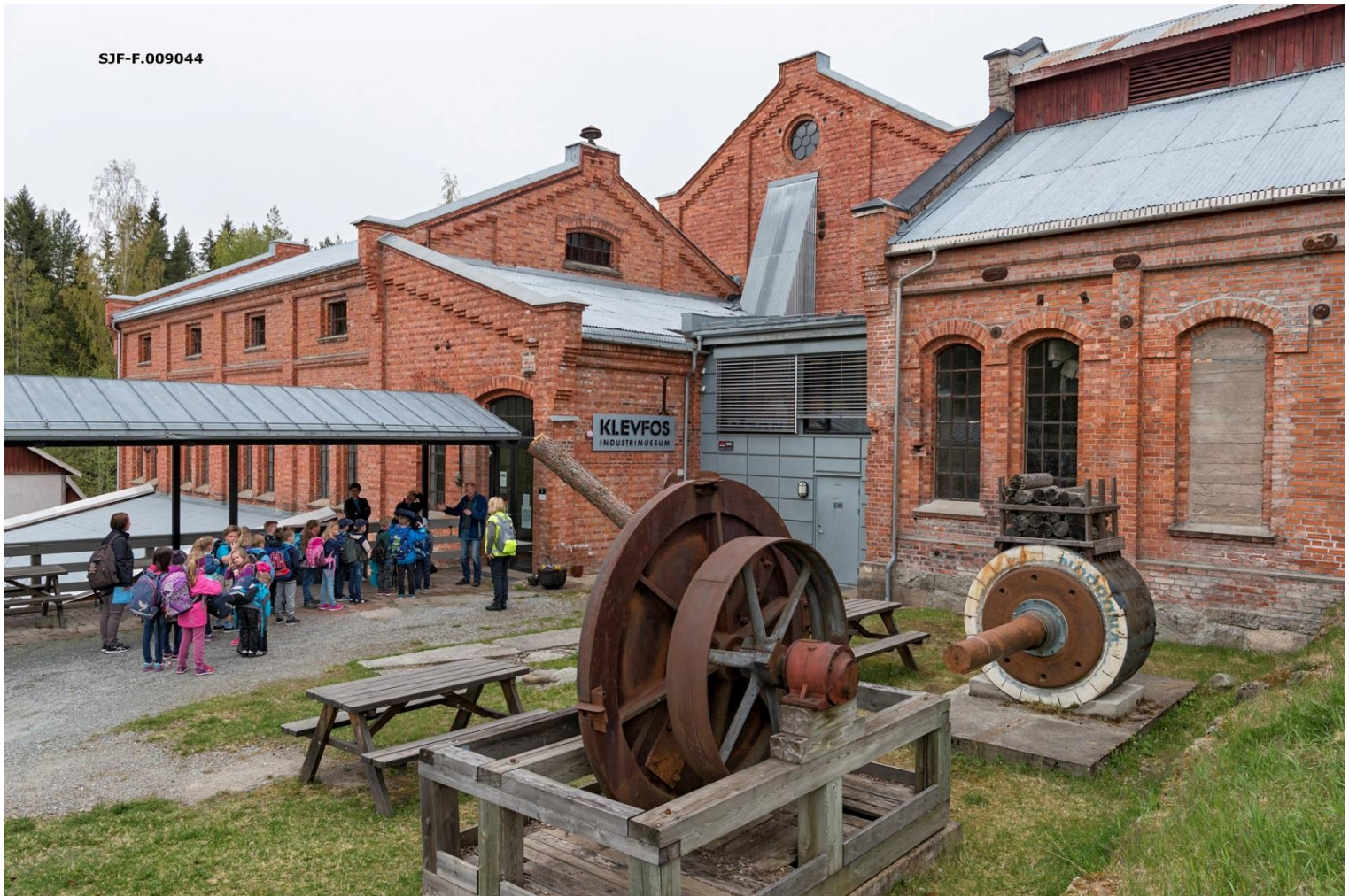
Fra Klevfos Industrimuseum på Ådalsbruk i Løten. Fotografiet er tatt på østsida av fabrikkkomplekset der museet har lagd et publikumsmottak ved inngangen til det som en gang var fabrikkens hoggeri. I forgrunnen, under åpen himmel, står et roterende stålhjul, som ble brukt til å produsere slik flis. Ved siden av ser vi et slipeapparat, brukt til å produsere tremasse. Foran inngangen til museet ser vi elever fra 2. trinn ved Stavsberg skole i Furnes (Ringsaker kommune) foran inngangen til museet. Klevfos-fabrikken ble etablert i 1888. Den bebyggelsen vi ser her ble oppført etter en brann i 1909. Fabrikken var i drift fram til 1976, og den ble gjenåpnet som museum ti år seinere. Foto: Bård Løken, Norsk Skogmuseum, SJF-F.009044
