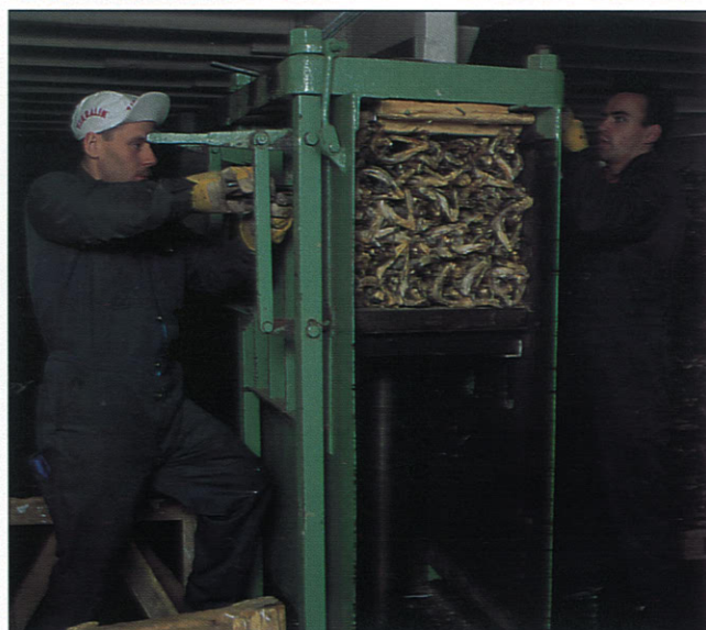
En hydraulisk presse brukes for å presse bunter med tørrfisk sammen.
