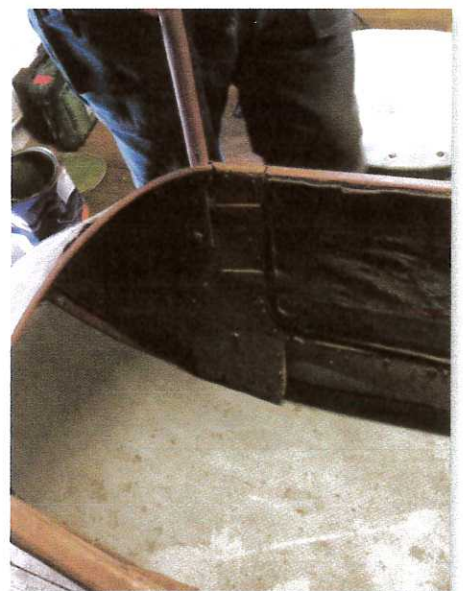
Det kraftige inn- og utstignings håndtaket som er standard utrustning. På toppen av buen over knærne kan skimtes sporet etter et hengsel fra den lokalt tilvirkede "Vestlandsvær beskyttelsen", en tynnplate konstruksjon som sammen med en vindskjerm gav passasjeren ekstra god beskyttelse mot støv, blæst og regn. I den restaurerte utgaven er det lagt ned en "tilje" av Redwood bord for å gi isolasjon mot kulde mellom stålbummen og støvle og skosåler.
