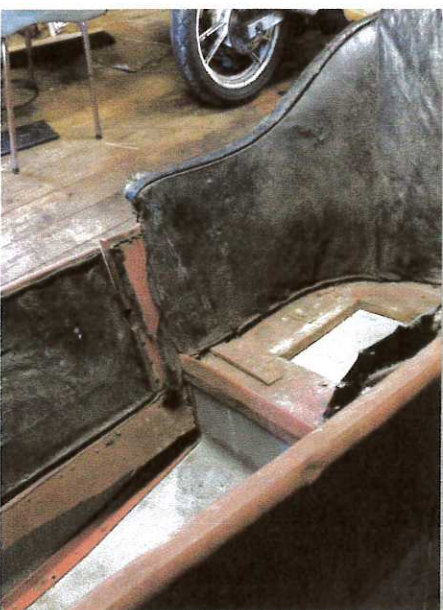
Avstiving av sideveggen bak døren og utformingen av treverket i bunnen under setet med utsparring for verktøykassen under setet.
