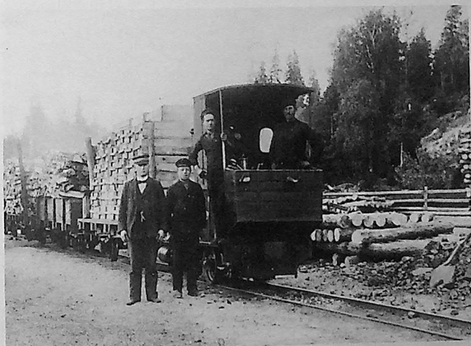
Som vi ser har hytta fått framvegg og trelemmer på siden, dessuten en redskapskasse bak. Foto: L. Welander
