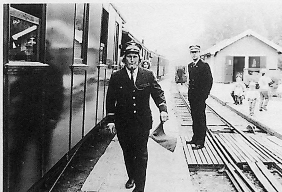
Avgang! Togfører Håvard Pedersen gir avgangssignal for tog 22 på Bingsfos. Togleder/txp Steinar Norli har nettopp utvekslet avgangsmelding med txp på Sørumsand, og har meddelt togføreren "klart for tog 22".
