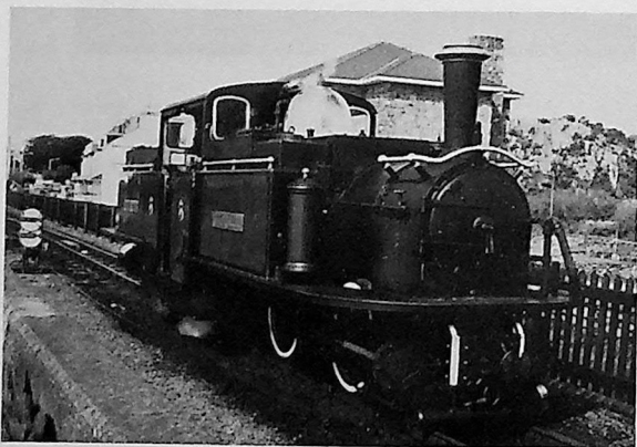
"Merddin Emrys" fra 1879 i Portmadoc. Merk vakumbremse-slangen og oljetanken oppå kjelen. Lok av denne typen har adskilte kjøreorganer for hver maskinboggi.
