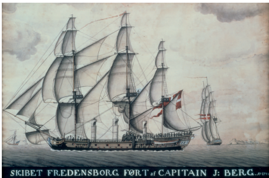
Figur 2. Fredensborg II, bygget noen få år etter forliset til Fredensborg I, men med alle slaveskipets kjennetegn. I forkant av stormasta vindfangere til å ventilere lasterommet til mannslavene. Der er også to forskansninger mot slaveopprør. Kvinneslavene holdt til i akterskipet og hadde i motsetning til mennene eget avtrede. Her i forkant av storbåten. Foto: Handels- og Søfartsmuseet, Helsingør.
